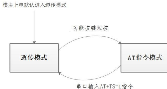
图 7 透传模式和AT命令模式的转换逻辑示意图
