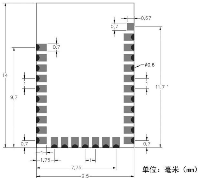
图 2 模块尺寸图示
