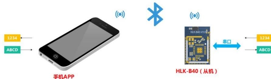
图 5 一对蓝牙连接透传功能示意图
