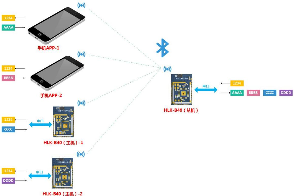
图 6 多对一蓝牙连接透传功能示意图
