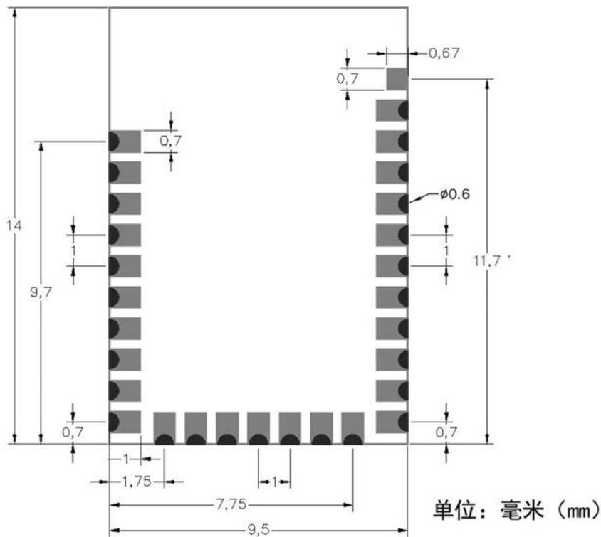
图 2 模块尺寸图示
