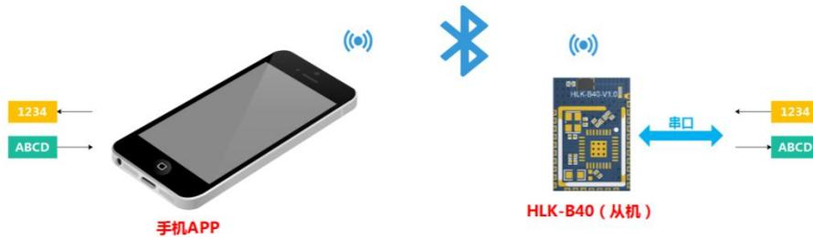
图 5 一对一蓝牙连接透传功能示意图
