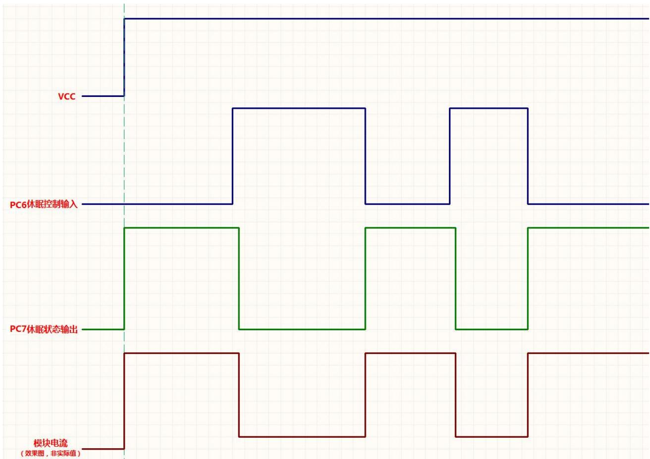
图 11 低功耗功能开启后的控制和状态时序
